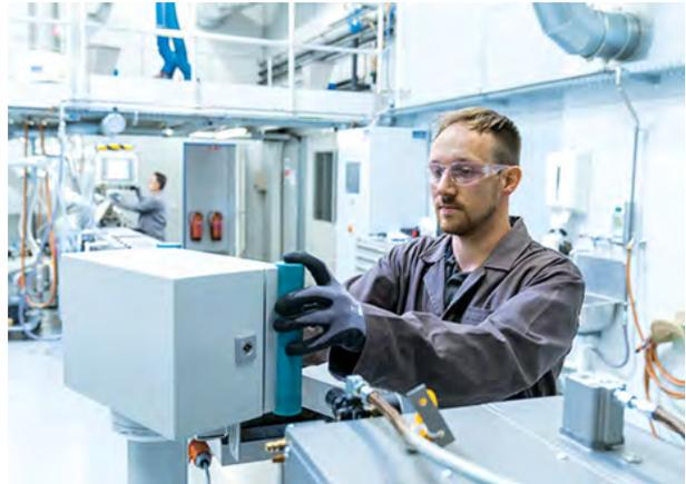
Ein Freudenberg-Mitarbeiter beim Aufbereiten von polymeren Werkstoffen mit einem sogenannten Zweischneckenextruder
