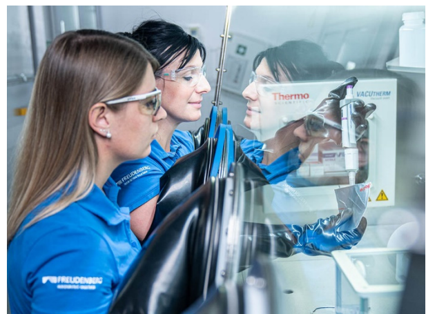
Mitarbeiterinnen von Freudenberg nehmen einen Versuch in einer Glovebox unter Schutzgas vor.
